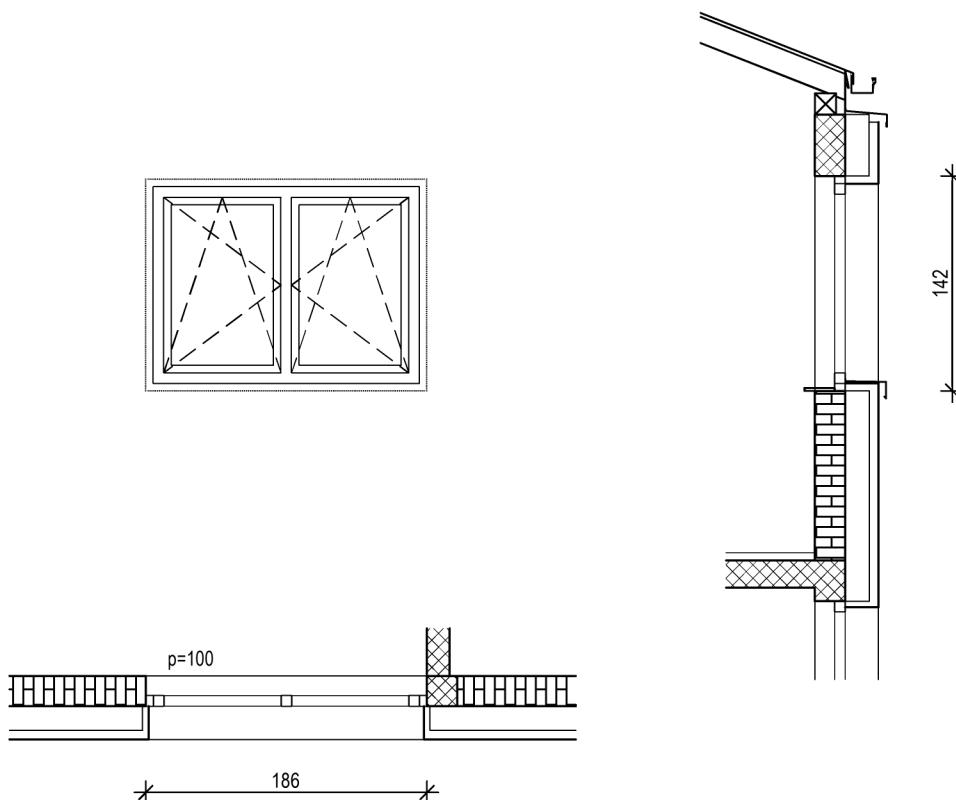
Izrada, dostava i montaža s RAL ugradnjom (vanjske i unutarnje RAL trake ) dvokrilnog prozora u građ. otvor vel. 186x142cm.
