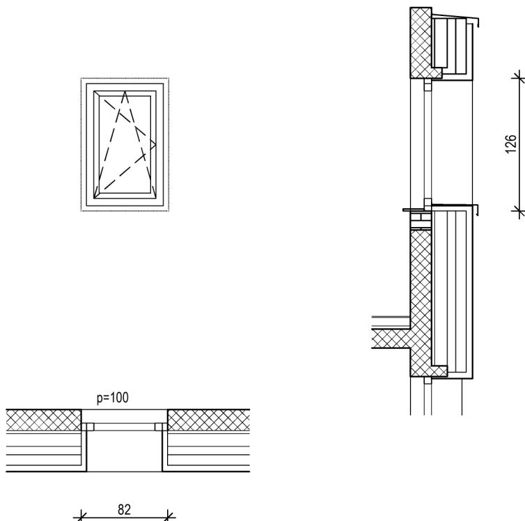
Izrada, dostava i montaža s RAL ugradnjom (vanjske i unutarnje RAL trake ) jednokrilnog prozora u građ. otvor vel. 82x126cm.
