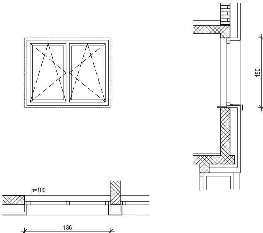
Izrada, dostava i montaža s RAL ugradnjom (vanjske i unutarnje RAL trake ) dvokrilnog prozora u građ. otvor vel. 186x150cm.
