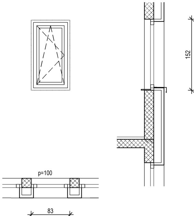
Izrada, dostava i montaža s RAL ugradnjom (vanjske i unutarnje RAL trake ) jednokrilnog prozora u građ. otvor vel. 83x152cm.
